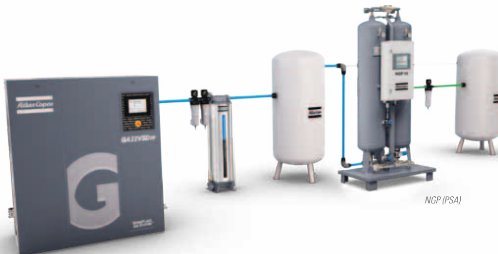
Typische Installation: Kompressor mit integriertem Trockner, Vorfiltern, Aktivkohlefilterbehälter QDT, Behälter, NGP-Stickstoff-PSA-Generator, Nachfilter, Behälter
